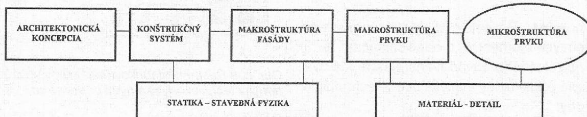
Tvarové vyjadrenie vychádzajúce z koncepcie diela sa vzájomne prelíná s pracovnými postupmi spracovania dokumentácie a vyúsťuje do záverečného návrhu reprezentovaného výrobnými výkresmi. Architekt tak v súčinnosti so statikom, stavebným fyzikom a technológom stvára detail do konečného tvaru. V zásade pri všetkých analytických procesoch rozlišujeme: makroštruktúru budovy, makroštruktúru prvku a mikroštruktúru prvku. Hierarchia stupňa riešenia je znázornená na obr. č. 8.
