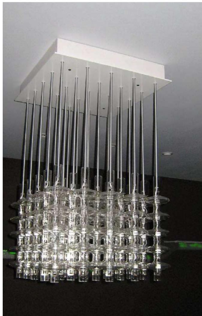
**.. Svítidlo Wanetlight je ovládáno gestikulací. Světelný zdroj 5 x 5 x 5 LED vytváří 3D světelnou síť. Každá dioda je ovládána individuálně. Ruční radiofrekvenční ovládač vysílá senzorům řídící příkazy rozsvěcující a zhasínající světelné diody v různých časových a prostorových sekvenčích a intenzitách.**
