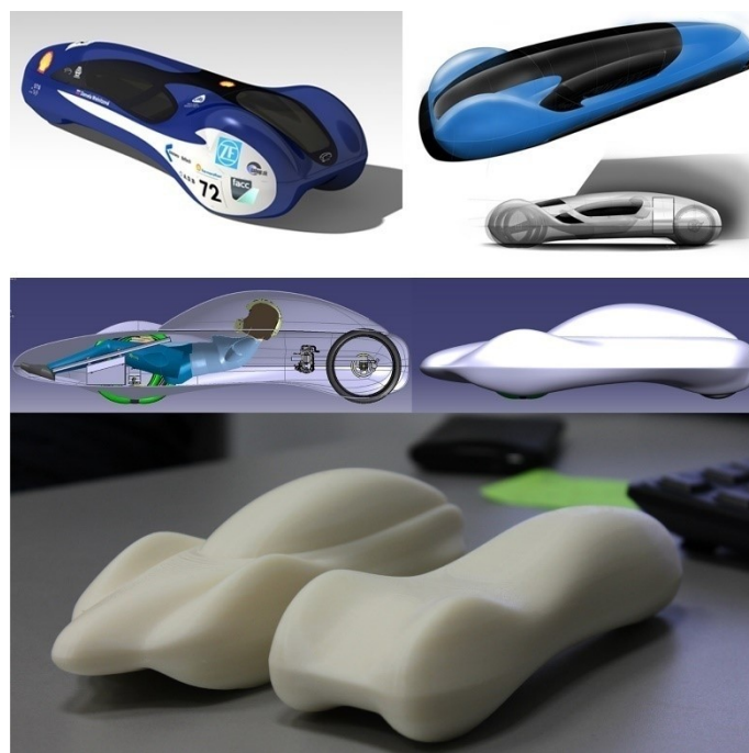
Obrázok 4: Futuristic Prototype, proces navrhovania (2013/2014) – skice, Marián Ščipa. Tento návrh sa nakoniec dostal najďalej a po úpravách sa stal základom výsledného tvaru karosérie; vizualizácia, na základe návrhu Petra Volárika sa testoval na prvý „package“ od FME; model, FME, oba návrhy ako modely v mierke 1 : 10 na test v aerodynamickom tuneli. Zdroj: osobný archív autorov
