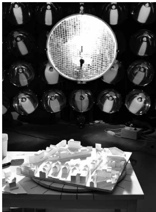
1 Svetelné laboratórium (lightlab, umelá obloha) Dunajskej univerzity v Kremsi. Foto: Gregor Radinger, 2019
